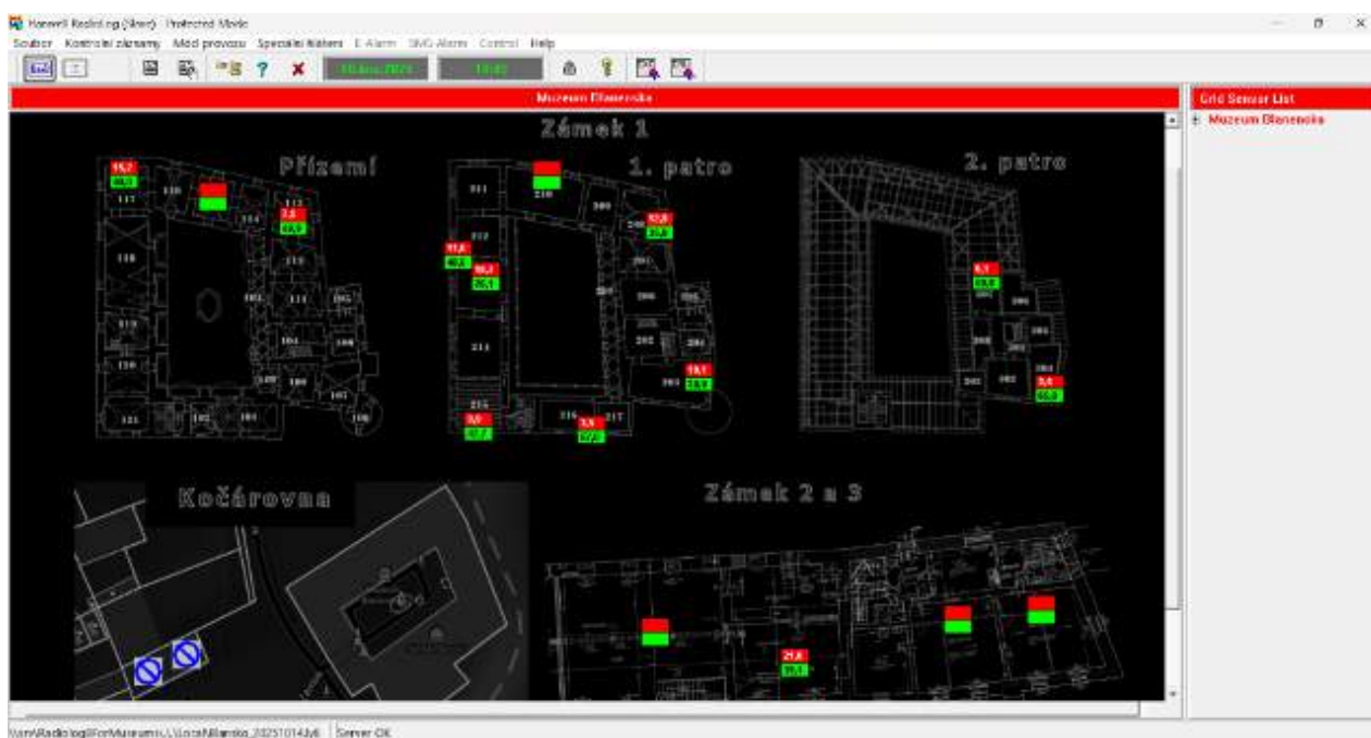
Obr. 1: Plánek rozmístění šestnácti čidel RV/T v místnostech expozic a depozitářů budov Zámku 1, 2, 3 a budoucí plán pro depozitář v Kočárovně.
